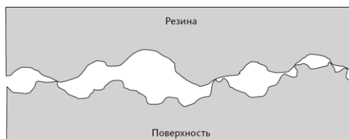
Рис. 4.3 – Соприкосновения двух твердых тел: вид под микроскопом
