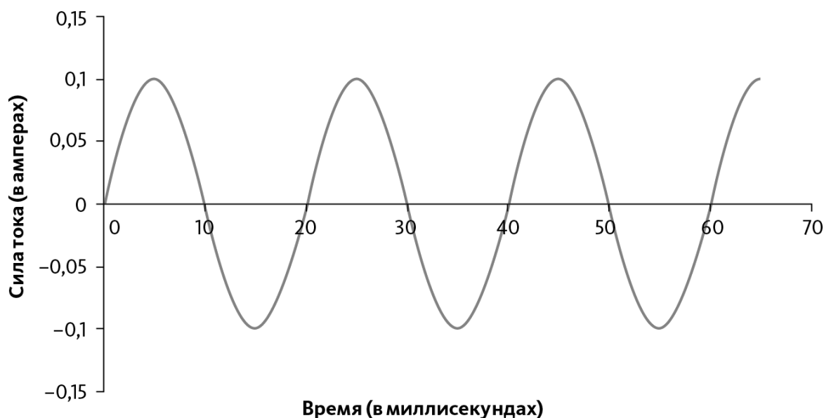
Рис. 16.5 – Сила тока, вырабатываемого генератором переменного тока
